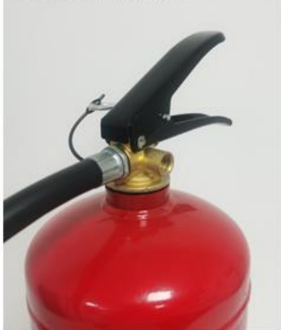
2. 用扳手拧下原装压力表。
