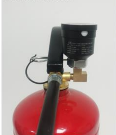
6. 拧开传感器盖子，将启动开关拨到开启位置，观察指示灯，确保通讯正常及后台数据正常。
