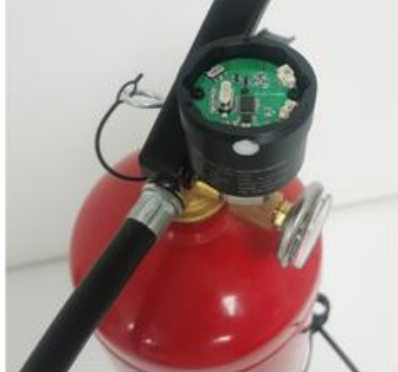
6. 拧开传感器盖子，将启动开关拨到开启位置，观察指示灯，确保通讯正常及后台数据正常。
