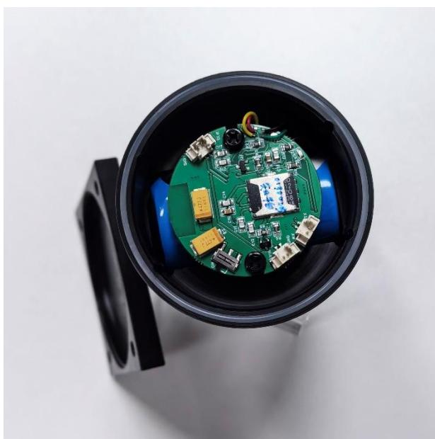
2、PCBA 板中找到产品开关，用摄子或小型一定螺丝刀，把开关拨到“NO”位置，
